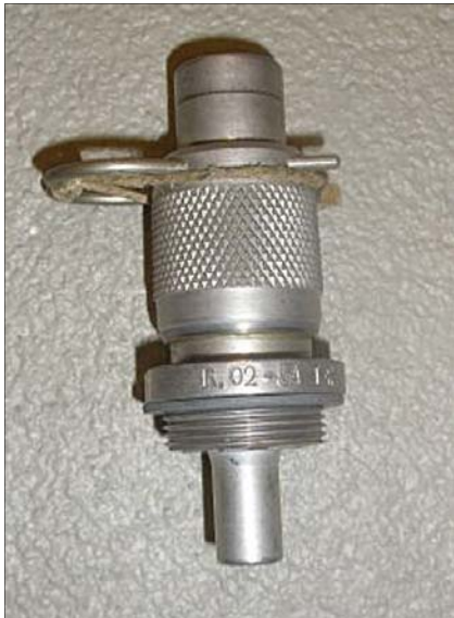
9 Der Druckzünder mit dem Gewinde zum Einschrauben in den Minenkörper. Am randierten Hals lässt er sich gut fassen. Er wird nur leicht festgezogen. Oben wird der Druckteller aufgesetzt.
