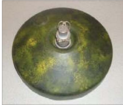
8 Die Mine mit abgenommenem Druckteller. Der Zünder ist eingeschraubt, der Vorstecker ist noch angebracht und festgebunden.
