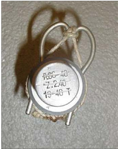
10 Der Druckzünder von oben gesehen. Gut zu erkennen ist der U-förmige Vorstecker, der mit einer Schnur am Zünder festgebunden ist.
